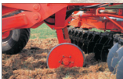
T-ringsvalse Ø 660 mm – 105 kg/m
