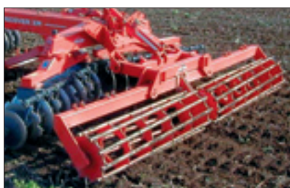
Rørpakkervalse Ø 550 mm – 75 kg/m
